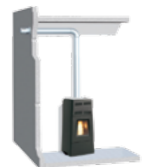
Zone 3 (terminal horizontal « ventouse »)
